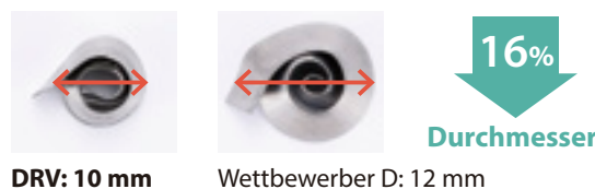
Vergleich der Spanform an Außenschneide der Wendeschneidplatte (Interne Auswertung)
