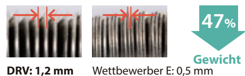
Vergleich der Steigung für von Innenschneide erzeugte Späne (Interne Auswertung)
