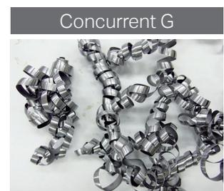
Conditions de coupe :  $V_c = 150 \text{ m/min}$ ,  $f = 0,05 \text{ mm/tr}$ ,  $d = 8 \text{ mm}$ , arrosage, largeur d'arête 4 mm, pièce : 15CrMo4, gorge
